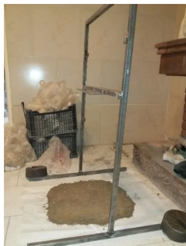
شکل ۵- (الف) شکل شماتیک پایه قرارگیری دوربین، (ب) تصویر پایه قرارگیری دوربین در آزمایشگاه
