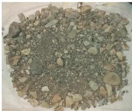
شکل ۶- تصویر نمونه‌های (الف) GW و (ب) SM در شرایط نور ثابت
