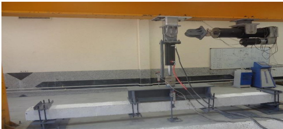
شکل ۳ - نحوه ی بارگذاری تیر بتن مسلح در محیط آزمایشگاه قبل از بارگذاری
