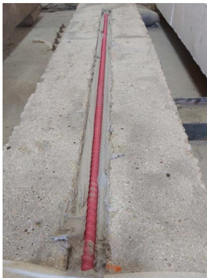
شکل ۱۱. نحوه قرارگیری میلگرد GFRP در وسط تیر بتن مسلح
