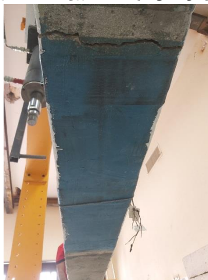
شکل ۹ - مکانیسم شکست در تیر بتن مسلح تقویت شده با ورق CFRP
