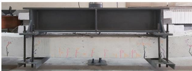
شکل ۸. مقایسه تیر بتن مسلح تقویت شده با ورق CFRP بعد از بارگذاری - RBI
