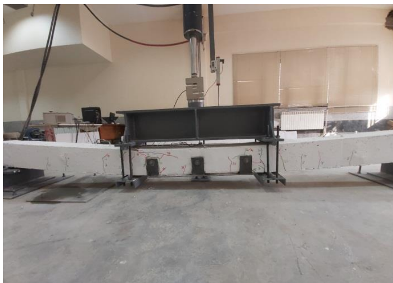
شکل ۱۵- نحوه بارگذاری تیر بتن مسلح تقویت شده با ورق فولادی
