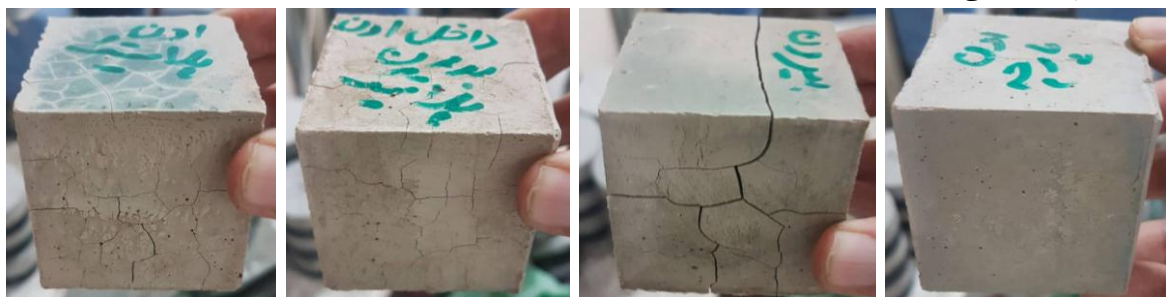
شکل ۶- ترک خوردگی نمونه‌ها در شرایط مختلف عمل‌آوری، الف) با پلاستیک و پارچه خیس درون اون، ب) دمای اتاق بدون پلاستیک، ب) بدون پلاستیک درون اون، ت) با پلاستیک درون اون
