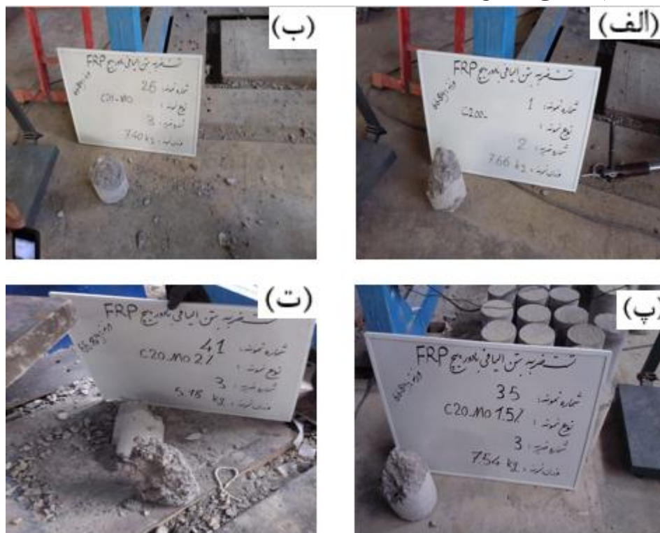
شکل ۳۴- مد شکست نمونه‌ها با مقاومت ۲۰۰ کیلوگرم بر سانتی‌متر مربع. (الف) - نمونه بدون الیاف. (ب) - نمونه با درصد الیاف. (پ) - نمونه با ۱/۵ درصد الیاف. (ت) - نمونه با ۲ درصد الیاف.
