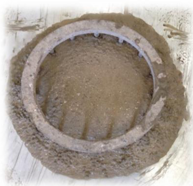
آزمایش J-Ring طرح ۰/۲٪ پلی پروپیلن
