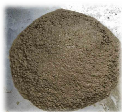
ب) آزمایش جریان اسلامپ طرح ۰/۲٪ پلی پروپیلن
