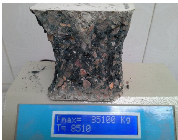
شکل ۹- نمونه ۹۰ روزه شکسته شده ۴ مولار با ۲۰٪ دوده سیلیس
