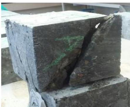
شکل ۲۸- الگوهای شکست نامطلوب نمونه های مکعبی قالب گیری شده در قالب های پلاستیکی دو تکه
