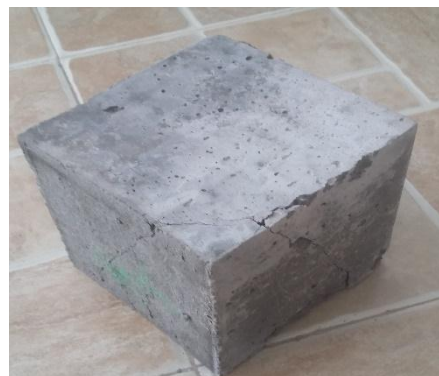
شکل ۲۸- الگوهای شکست نامطلوب نمونه های مکعبی قالب گیری شده در قالب های پلاستیکی دو تکه
