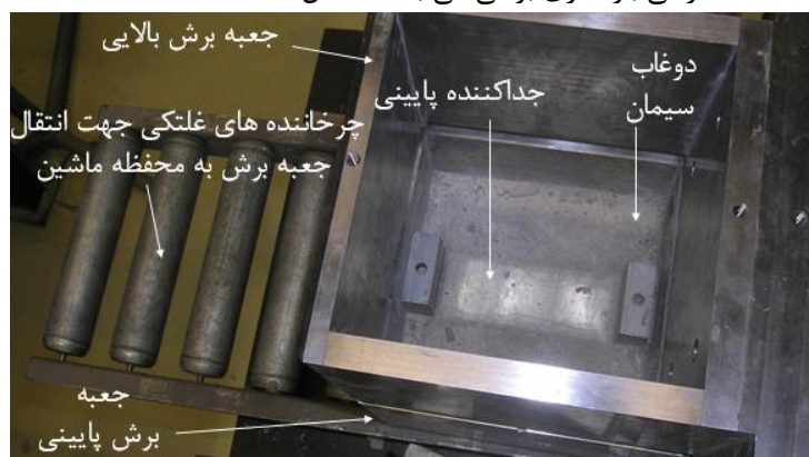
شکل ۱۰- ثابت شدن جداکننده پایینی در جعبه برش توسط دوغاب سیمان سخت شده.
