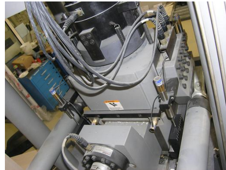
شکل ۴ - نماهای مختلف دستگاه برش مستقیم MTS، الف) نمای روبرو، ب) نمای کناری و ج) نمای عقب.
