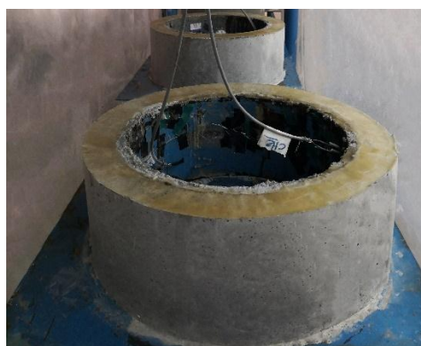
شکل ۵. حلقه بتنی تحت آزمایش
