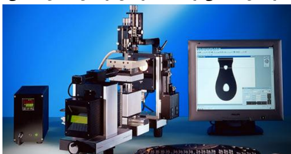
شکل ۲ نمایی از دستگاه اندازه‌گیری زاویه تماس
