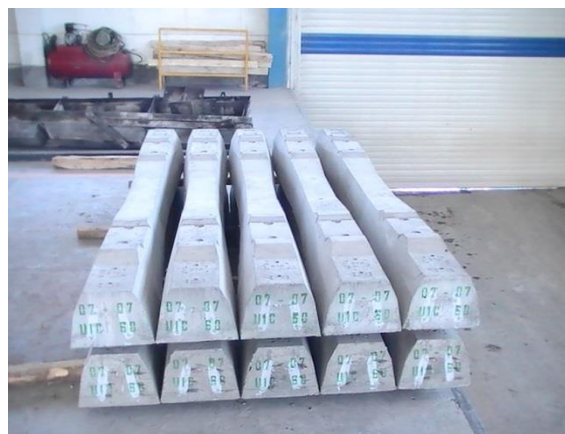
شکل ۵. تراورس بتنی پیش‌تنیده B70.
