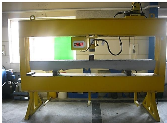
شکل ۶. سیستم جک آزمایش سه نقطه‌ای خمشی.
