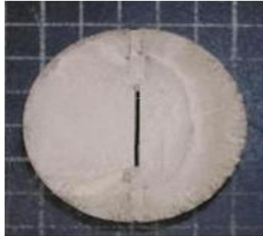
شکل ۲- نمونه دیسکی حاوی درزه مرکزی به طول ۲۰mm
