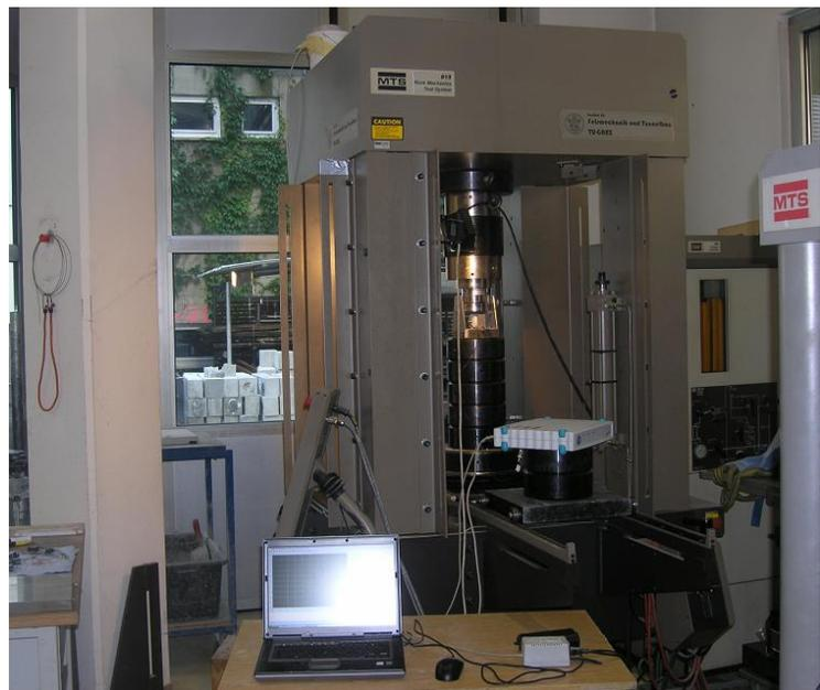
شکل ۳- ماشین آزمایش تک محوره
