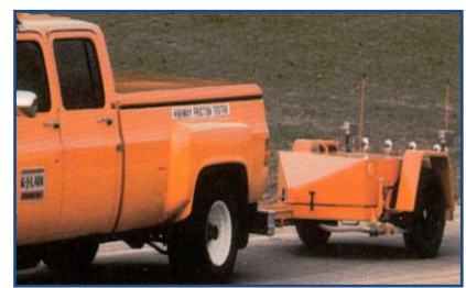
روش چرخ‌های قفل‌شده (Locked Wheel FT)
