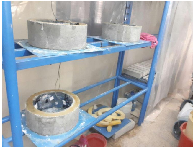
شکل ۴- آزمایش جمع شدگی ناشی از خشک شدن بتن مقید.
