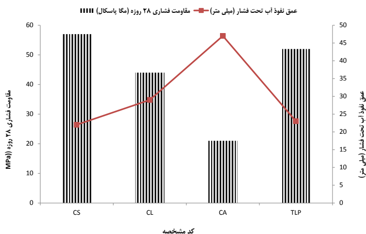
شکل ۵- ارتباط بین مقاومت فشاری و عمق نفوذ تحت فشار آب
