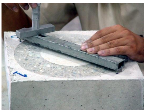
شکل ۳- دستگاه آزمایش ASTM C779 (دیسک چرخان) و نحوه قرائت عمق سایش بعد از انجام آزمون مطابق ASTM C779
